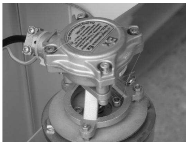
Рисунок В.3 Пломбировка генератора импульсов
