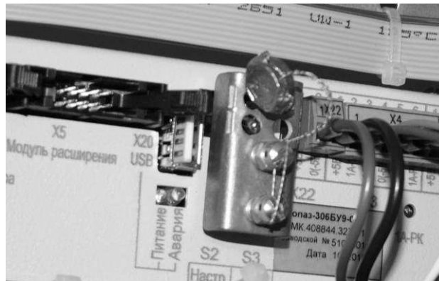
Рисунок В.1 Пломбировка блока управления
