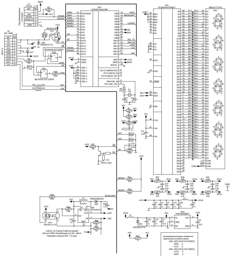
Рисунок 1 – Схема электрическая принципиальная (лист 1)
