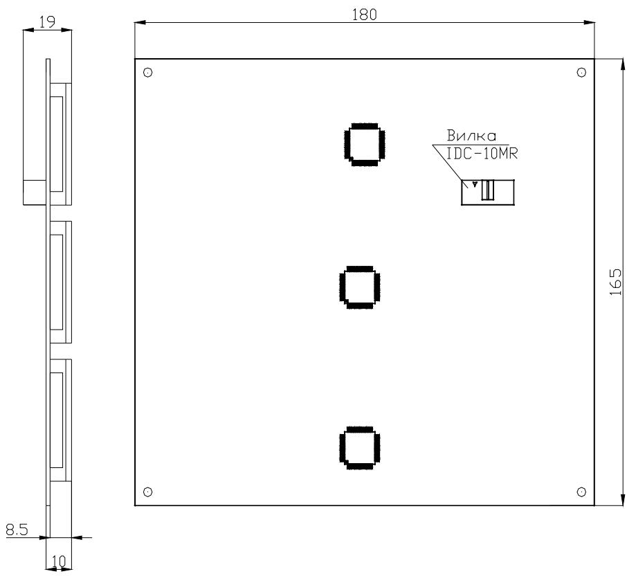
Рисунок 4 – Габаритные и установочные размеры
