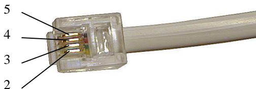
Нумерация контактов вилки 6Р4С (контакты 1 и 6 отсутствуют)
