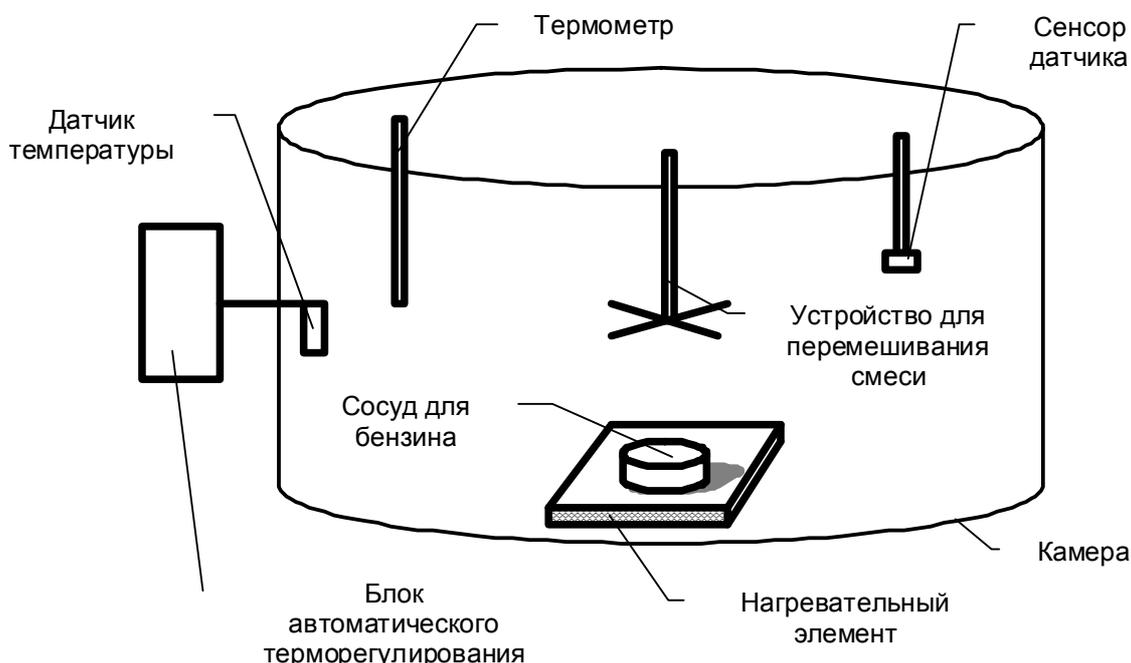
8.2. Рассчитать количества жидкого вещества, необходимого для создания заданных концентраций его паров в камере с известным объемом при постоянной температуре, по формуле (ГОСТ Р 51330.2-99):
