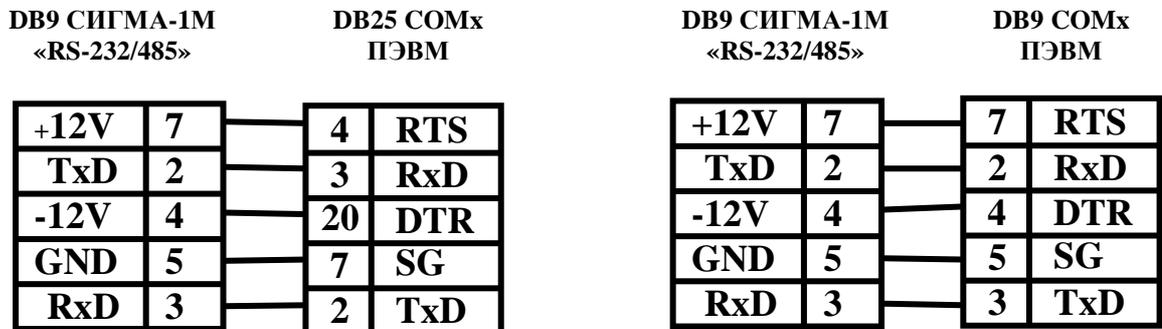
Рис. 4. Подключение газоанализаторов "СИГМА-1М" к ПЭВМ (RS-232).
