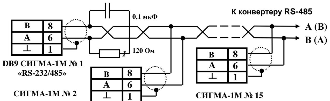
Рис. 5. Подключение газоанализаторов "СИГМА-1М" к сети RS-485.
