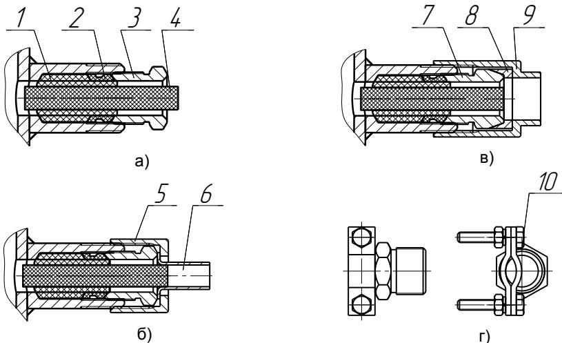
1 – кольцо уплотнительное; 2 – удерживающее устройство; 3 – втулка резьбовая; 4 – заглушка; 5 – втулка резьбовая из комплекта УКМ; 6 – трубка из комплекта УКМ; 7 – втулка резьбовая из комплекта УКБК15; 8 – шайба из комплекта УКБК15; 9 – втулка резьбовая из комплекта УКБК15; 10 – комплект УК16.
