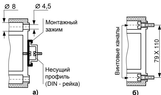
Рисунок 7 - Варианты крепления изделия обычного исполнения
