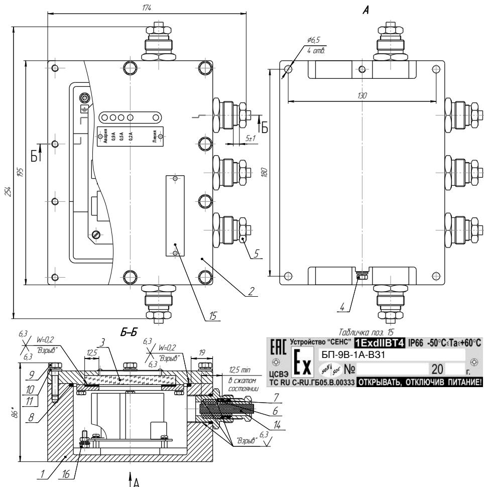
1 – Корпус (Амг6); 2 – Крышка (Амг6); 3 – Окно смотровое (плексиглас); 4 – Зажим наружного заземления: болт М5, шайба пружинная, шайба (2 шт); 5 – Втулка резьбовая (сталь); 6 – Втулка уплотнительная (резина); 7 – Цангa (полиациеталь / полиамид); 8 – Прокладка (резина); 9 – Болт М6; 10 – Шайба; 11 – Шайба пружинная; 14 – Шнур заглушки (резина); 15 – Табличка (Амг2); 16 – Зажим внутреннего заземления: гайка М4, шайба пружинная, шайба (2 шт).
