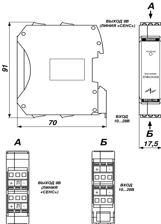
Рисунок 1 - Внешний вид. Размеры. Назначение контактов
