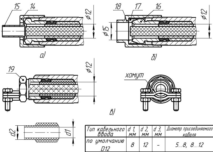
14 – втулка резьбовая из комплекта УКМ; 15 – трубка из комплекта УКМ; 16 – втулка нажимная резьбовая из комплекта УКБК-15; 17 – шайба конусная из комплекта УКБК-15; 18 – втулка резьбовая из комплекта УКБК-15; 19 – втулка нажимная резьбовая из комплекта УК-16.
