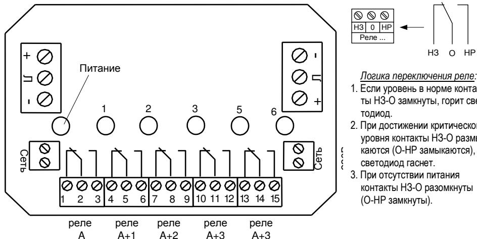
Рисунок А.3 – Расположение контактов на плате. Логика переключения реле.
