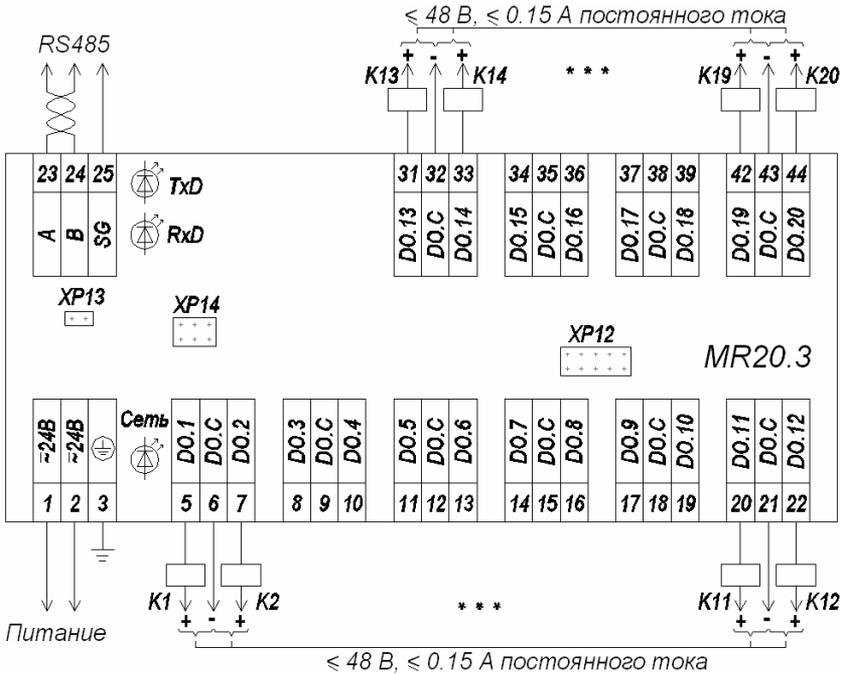
Рисунок 2 – Схема подключения внешних соединений к модулю MR20.3
