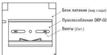
Рис.6 – Крепление приспособления на блоке питания
