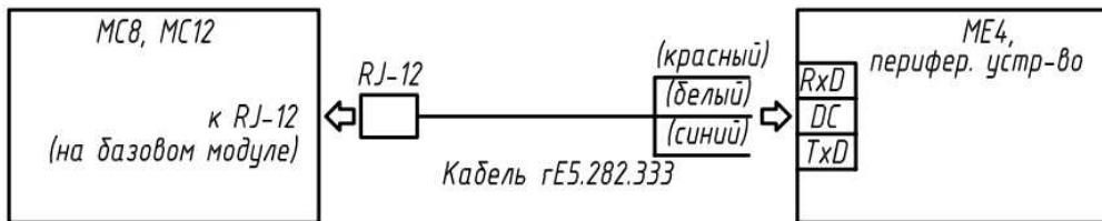
Подключение периферийного устройства к контроллеру по каналу RS232.
