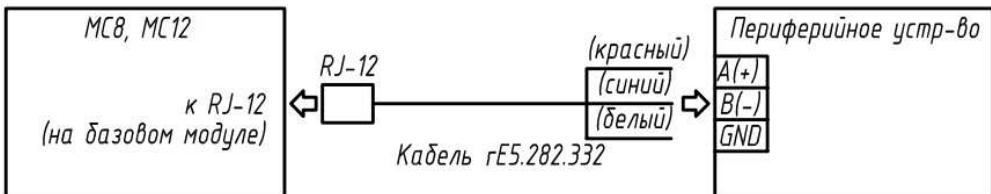
Подключение нескольких периферийных устройств к контроллеру по каналу RS485. Интерфейс RS485 дает возможность подключать напрямую несколько периферийных устройств последовательно к одному контроллеру. Количество подключаемых периферийных устройств ограничено объемом памяти контроллера. Рекомендуется подключать не более 4-х периферийных устройств.
