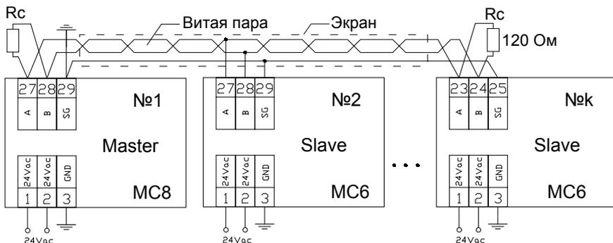
Рисунок 6 – Контроллеры, объединенные в сеть по интерфейсу RS485
