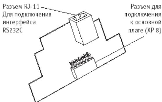
Рисунок 10 – Общий вид платы интерфейсного субмодуля RS232C
