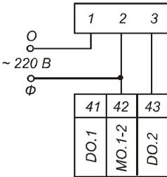
При подключении ИМ типа Belimo следует учитывать, что ток утечки симисторного ключа MC5 может достигать 2 мА ( $\cos \varphi = 0$ ).
