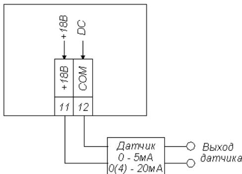
Рисунок 5 – Подключение цепей питания датчика 0-5, 0(4)-20 мА
