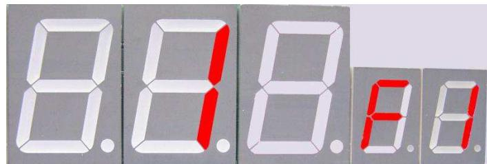
**2 F1** режим работы ТРК ручной (снять на ТРК раздаточный кран, набрать необходимое количество литров на клавиатуре ТРК, используя клавиши с цифрами, нажать клавишу «#» и подтвердить пуск красной кнопкой, через 4 сек включится насос ТРК).
