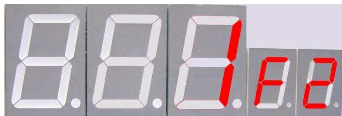
Где **F2** - электронная калибровка ТРК, а цифры перед F2 означают количество произведенных электронных калибровок на ТРК.
