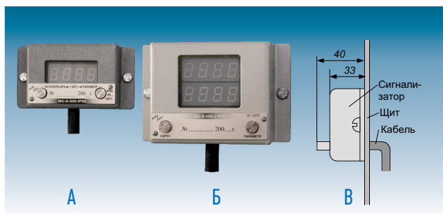
Рис. 13. Сигнализаторы ВС-K-500 (А) и ВС-K-500-2 (Б) поставляются с кабелем длиной 1,5 м (или другой длиной под заказ). Возможно исполнение с кабелем, выходящим из задней панели корпуса, предназначенным для монтажа сигнализатора на щите (В). Панель сигнализатора ВС-K-500 (В) может иметь надпись измеряемого параметра ("Уровень", "Температура"...) - по заказу для размещения на щите нескольких сигнализаторов с индивидуальной индикацией одного измеряемого параметра.
