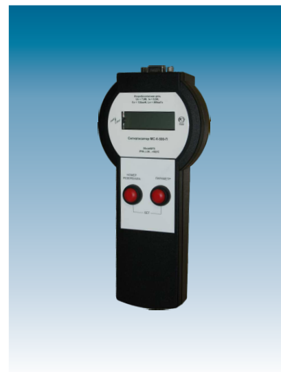
Рис. 12. Сигнализатор MC-K-500-П - переносной со встроенными элементами питания типа "AA". Применяется для просмотра параметров, настройки датчиков, не соединенных с линией системы измерительной "СЕНС".
